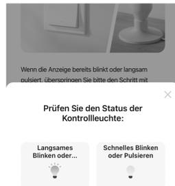
Nachdem du in der App zum nächsten Schritt gegangen bist, bittet dich die App den richtigen Status der Lampe zu wählen. Da wir die Lampe im vorherigen Schritt in den langsam blinkenden Verbindungsmodus gesetzt haben, wählst du in der App die linke Option aus.
