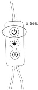
Um zwischen den Verbindungsmodi zu wechseln, hältst du den Power Knopf am Receiver der Lampe 5 Sekunden gedrückt. Die Lampe wird nun entweder schnell oder langsam blinken. Sollte die Lampe schnell blinken, wiederhole den Vorgang, bis diese langsam blinkt. Sobald die Lampe langsam blinkt, kannst du mit der Verbindung in der App fortfahren.
